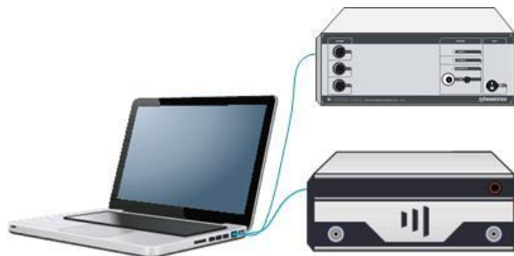
Рисунок 1. Подключение нескольких приборов к одному ПК.
